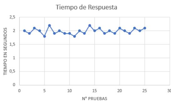
*Nota.* La imagen muestra las mediciones del tiempo entre la detención y el cierre de la hornilla. Fuente el autor, año 2024.
