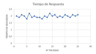
Nota. La imagen muestra las mediciones del tiempo entre la detención y el cierre de la hornilla. Fuente el autor, año 2024.
